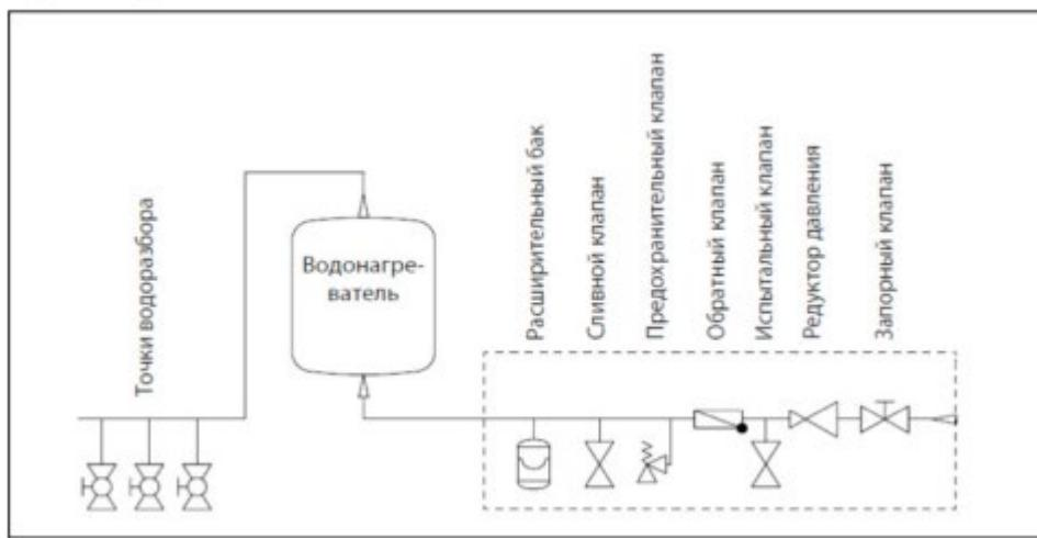
В случае превышения указанного в настоящей инструкции максимального рабочего давления воды, отсутствия предохранительного клапана, гарантия на водонагреватель утрачивает силу.
